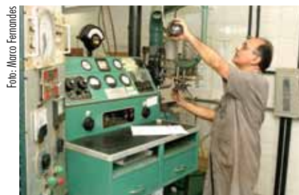
Laboratório de Máquinas Térmicas — Motor CFR/ASTM para determinação da octanagem de gasolina.
